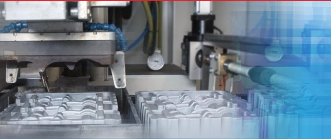
Wir fertigen mit einem technologisch aktuellen Maschinenpark im Vakuumthermo-Verfahren. Präzision, Qualität und Effizienz sorgen für einen flüssigen Produktionsablauf zu Ihrer Zufriedenheit.
